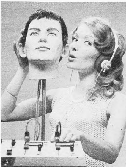
Bild 1. Der Kunstkopf „Oskar“, mit dem ein neues Stereo-Aufnahmeverfahren erprobt wird
