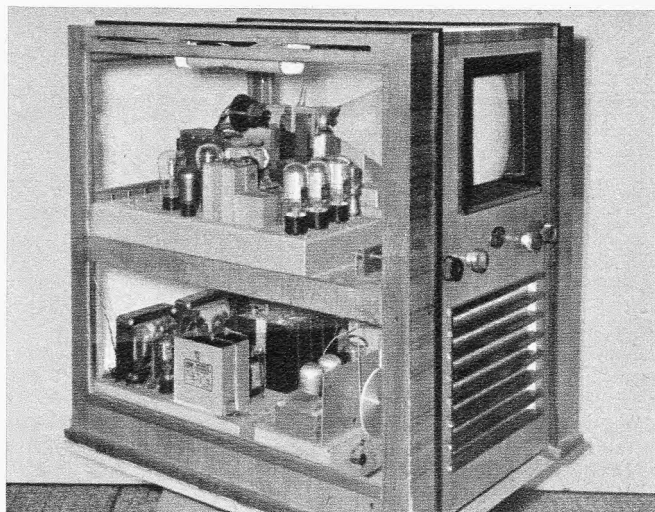
Die Bundespost zeigte auch historische Geräte – hier ein Fernsehempfänger der C. Lorenz AG von 1935. Bildgröße 18,5 cm × 22 cm (= Format 5 : 6). Die Norm war damals 180 Zeilen/25 Bildwechsel/s, man sprach von 40 000 Bildpunkten. Bemerkung eines Besuchers: Das waren noch echte Holzgehäuse . . .
